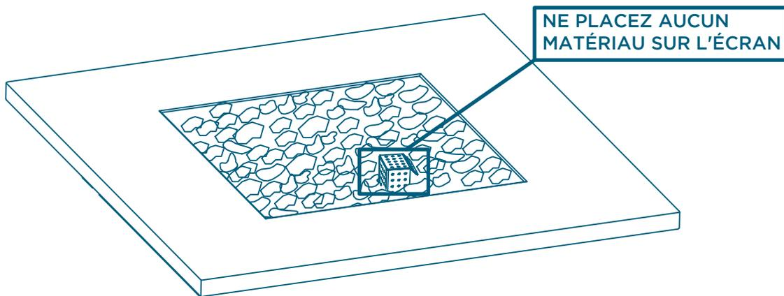
4. **IMPORTANT :** Ne placez pas les pierres de lave à une distance supérieure à 1 po (2,54 cm) au-dessus du brûleur. Assurez-vous qu'aucun morceau de verre ne recouvre l'écran de l'allumeur. Rangez le surplus de morceaux de verre dans un endroit sûr.
