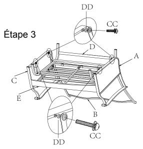
Étape 3 : Mettez les pièces assemblées à l'envers sur une surface molle. Fixez le socle (D) à l'accoudoir gauche (C) et à l'accoudoir droit (A) en alignant les trous de boulon du socle (D) avec les trous de boulon correspondants des accoudoirs (A et C). Insérez les boulons M6x35 avec rondelle (CC) et la rondelle-1 en plastique (DD). Serrez légèrement les boulons avec la clé hexagonale (FF).
