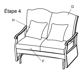
Étape 4 : Une fois que tous les boulons sont en place, serrez-les à fond. Remettez le fauteuil sur billes à l'endroit sur une surface plane et de niveau. Assurez-vous que toutes les fixations sont serrées solidement avant l'utilisation. Placez les coussins de siège (F), les coussins de dossier (G) et les coussins d'appoint (H) sur le fauteuil sur billes. Veuillez voir la figure .4.
