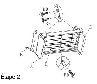
Étape 2 : Fixez le siège (E) aux accoudoirs (A et C) et au dossier (B) en alignant les trous de boulon du dossier (B) avec les trous de boulon correspondants des accoudoirs (A et C). Insérez les boulons M6x25 avec rondelle (BB). Serrez légèrement les boulons avec la clé hexagonale (FF). Ne serrez pas complètement.
